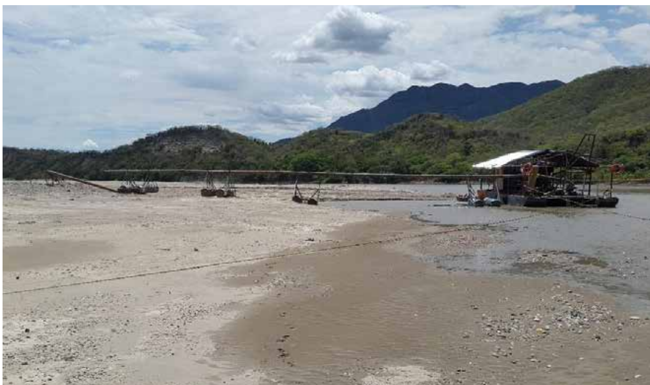
⬇ Figura 33. Draga para levantar arena y grava del lecho del río
