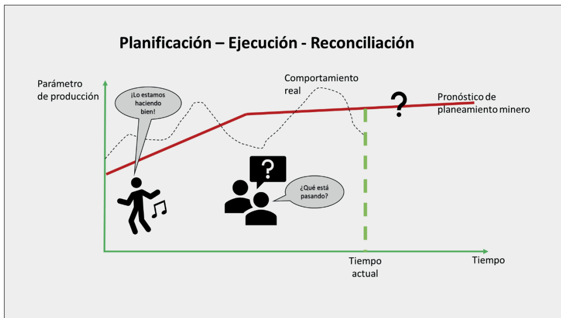
Figura 38: Relación entre planificación y ejecución (Modificado de Alegre y Smith, 2012).
